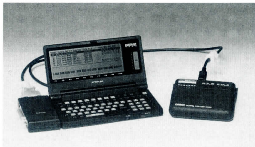
写真15 PTP-20にOMRON製のポケットモデムを接続しているところ
