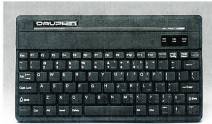
写真6 DTR-1に付属してくる82キーのキーボード。クリック感はいまひとつ
