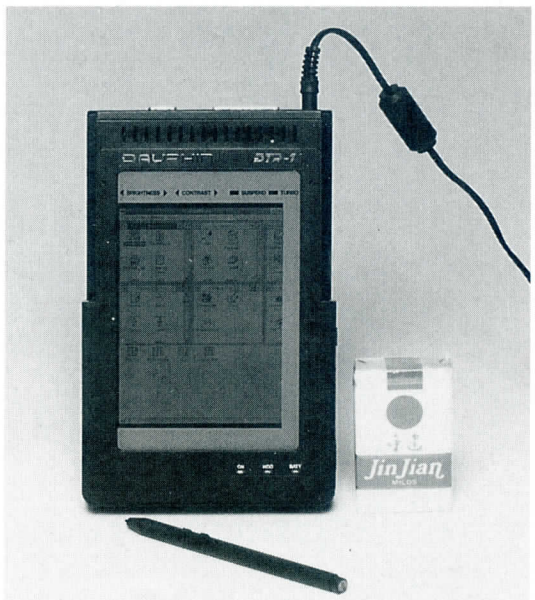
写真8 DTR-1を縦置きにして、Windowsを起動させたところ。横に置いてあるのは、大きさを比較するための中国製タボコ「Jin Jian」
