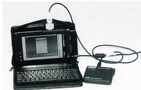
写真12 DTR-1のシリアルポートにポケットモデムを接続する
