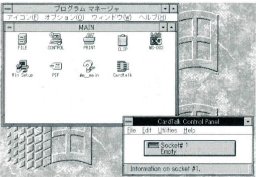
写真11 なにも入っていないときは「Socket # 1 Empty」と表示される
