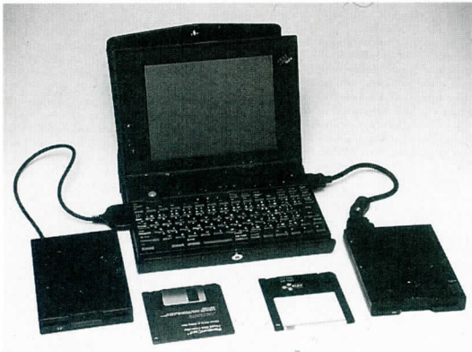
写真4 IBM TP220に、2基のFDDを接続する
