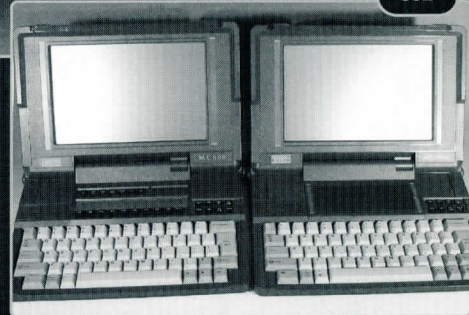
MC400(右)とMC600(左) この2機種は兄弟関係とも言えるが、仕様面ではまったく性格が異なる。MC400はPsion純正マルチタスクOS搭載のGUIマシン。片や「あの」MS-DOS Ver3.2を搭載した謎ば〜もどきマシン
