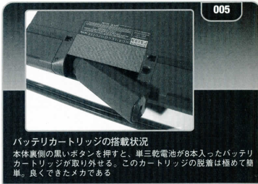
バッテリーカートリッジの構造 単三乾電池4本を1組とし、2段重ねでカートリッジに入れる構は、まるで銃に弾丸を装填するようだ。マニュアルをくすぐるニクイ演出かあ？
